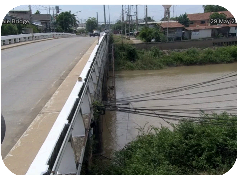
ระดับน้ำปัจจุบัน 25.69 ม.สทก. เกณฑ์วิกฤติ 30.55 ม.สทก.
